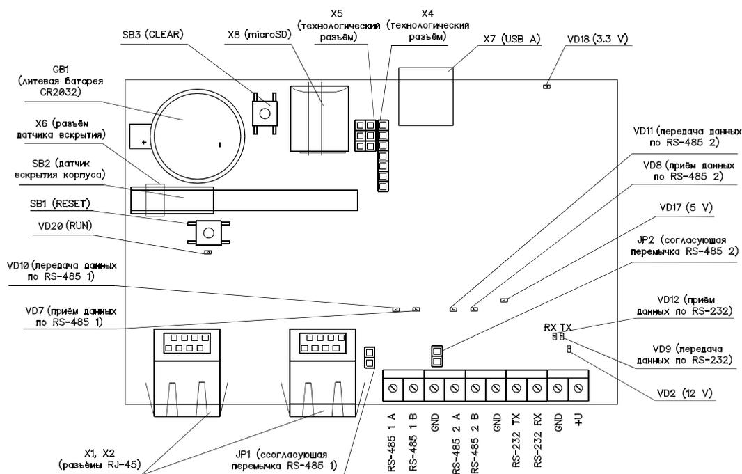
Рисунок 1. Схема расположения элементов КСК (аппаратная версия 2.3)
